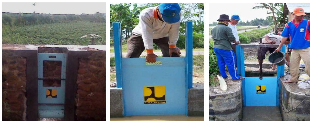
Gambar 8 Uji Coba Penerapan Pintu Fiberglass : (a) BCMK 23 Ki (Di Cimanuk, Garut); (b) Sub-Sekunder Gabus (Sekunder Kandang Haur, Di Jatiluhur, Patrol)
