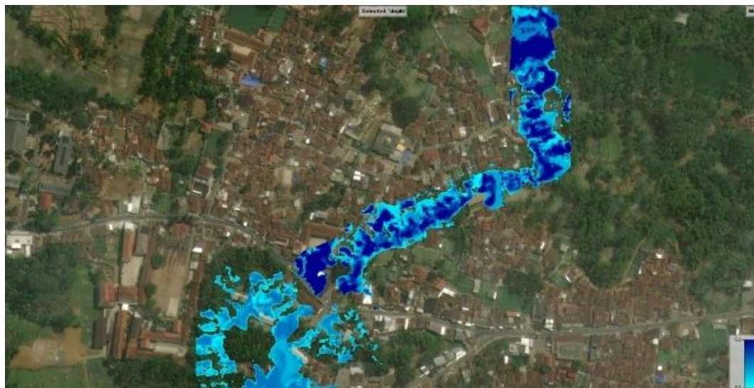
Gambar 6 Hasil Pemodelan Debit Q 25 tahun pada Sungai Citanduy eksisting yang di Overlay Terhadap Peta Topografi dan Satellite Imagery
